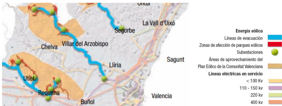
Imagen 22: Infraestructuras eléctricas de la CV. Fuente: Conselleria de Política Territorial, Obras Públicas y Movilidad. GVA.
